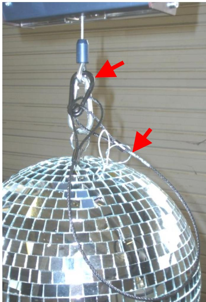
**Une charge suspendue minimale est nécessaire au fonctionnement du palan (Le palan est équipé d'un interrupteur de charge pour éviter un mauvais déroulement du câble et stopper la descente si la charge est immobilisée)**
